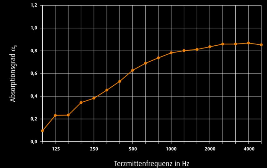
**Akustisch wirksame Oberfläche:** Höhe (einzeln): 2,00 m, Breite (einzeln): 1,19 m **Anzahl Prüfobjekte:** 3 Stück **Prüffläche:** 14,28 m<sup>2</sup>
